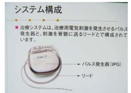
脊髄電気刺激装置のシステム
