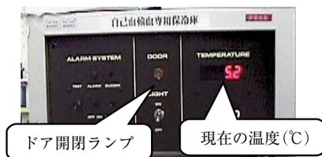
(写真1) 温度表示パネル・警報装置
